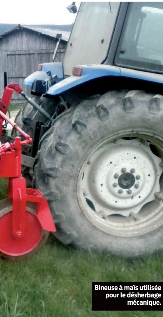
Bineuse à maïs utilisée pour le désherbage mécanique.
